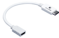
ADC-DPM/HF DisplayPort вилка на HDMI розетку. Для работы порт DisplayPort должен быть двухрежимным
