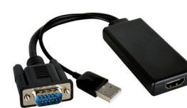
ADC-GM/HF Активный переходник VGA вилка на HDMI розетку
